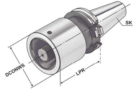
ISO 7388-1    Form AD     $\leq 3\mu\text{m}$     G6.3 15.000 min<sup>-1</sup>    RFID Chip    ISO 26623
